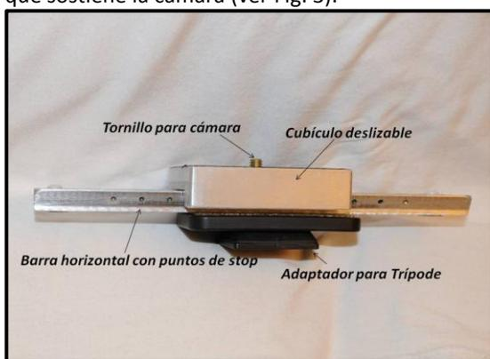
**Fig. 3.** Barra deslizante que fue utilizada para la obtención de las fotos para el presente trabajo; se pueden apreciar sus distintas partes.
