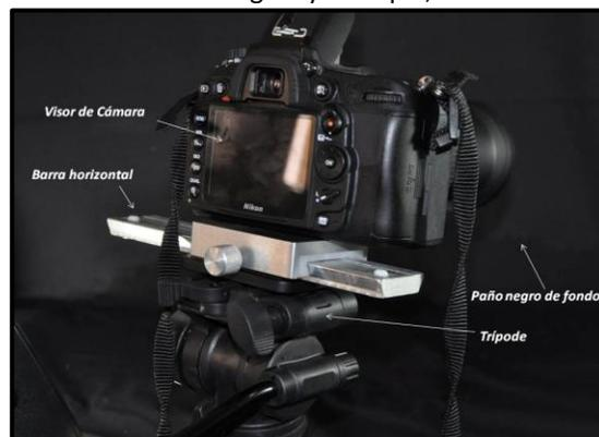
**Fig. 4.** Cámara Nikon D5000 colocada en la barra horizontal, sujeta al trípode.
